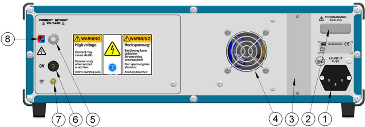
图：后面板–HCP 700-6500样品，带反极性开关。对于具有更高性能或其他电压的直流电源，其他尺寸可能适用。元素的布局可能与此处所示不同。
